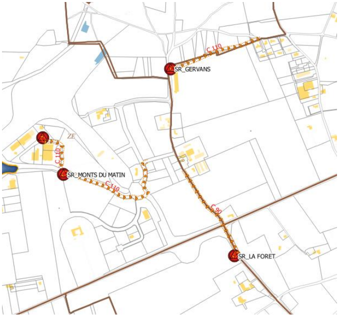
Les 4 postes de relevage et le réseau en refoulement
