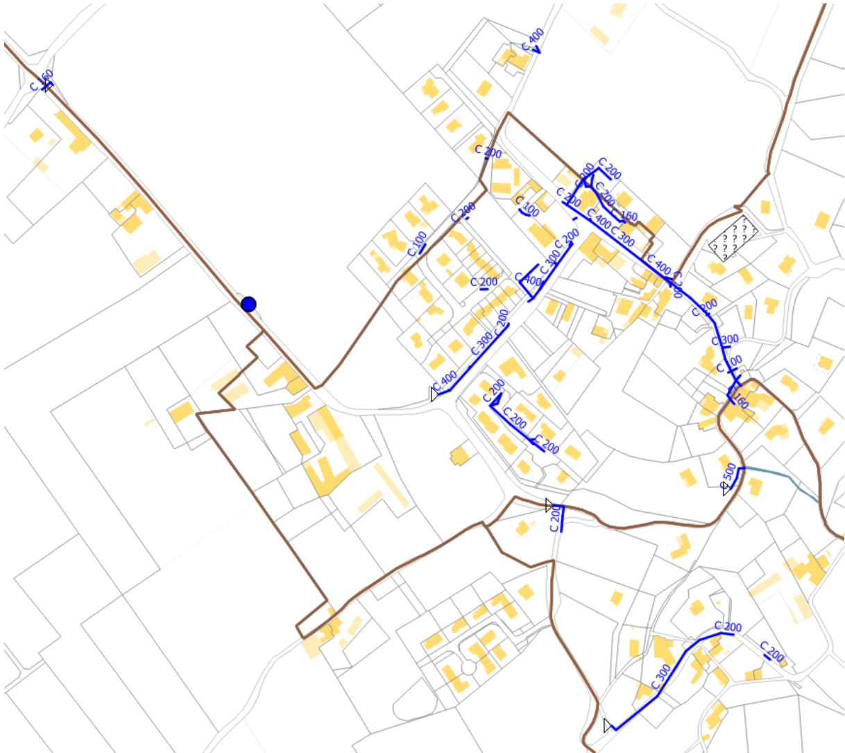
Réseau pluvial sur la commune d'Hostun
