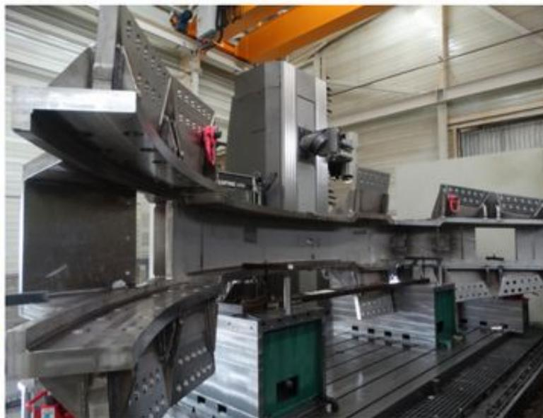
Marcel industrie vient de terminer les finitions ( l'usinage) de la neuvième structure de liaison inter-bobines (sur dix-huit) qui va partir chez SDMS pour poursuivre sa fabrication
